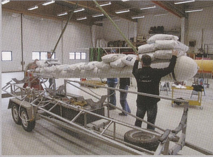
Strukturtest av målesensor
