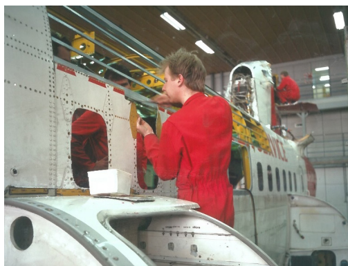
Større platereparasjon av Boeing Vertol BV234 etter at hovedrotorbladet slo ned i taket på maskinen i 1989.
