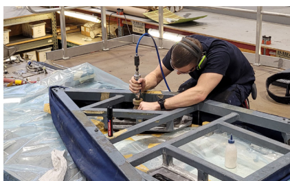
Nye hull borres ved hjelp av jig i nytt transmisjonsdekk på AS332 Super Puma
