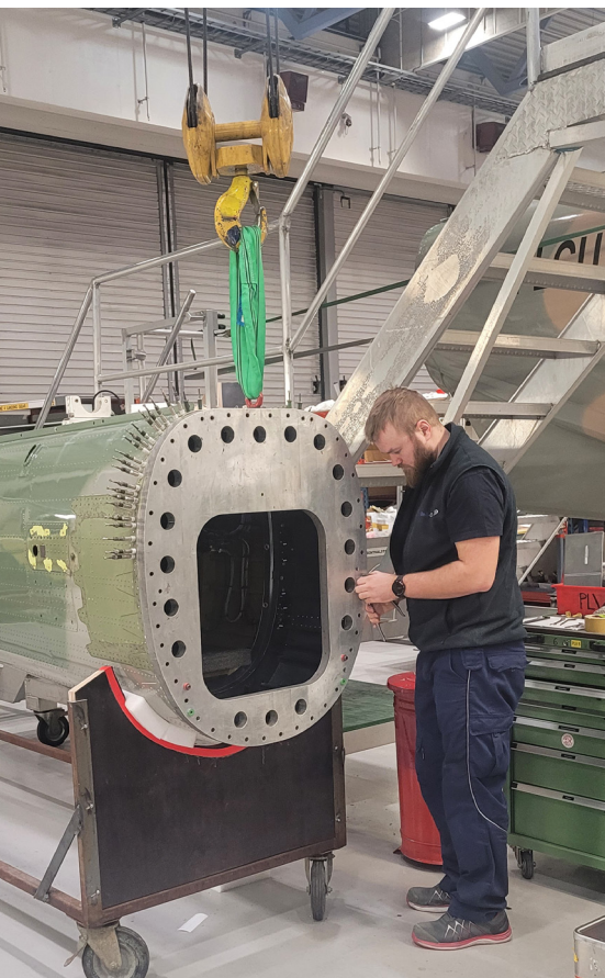
Stasjon 9000 byttes på en Super Puma hos Heli-One Norge. Her er jiggen montert.
