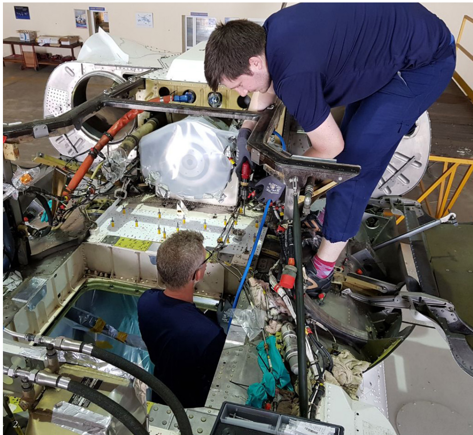
1. Delene som lages og repareres må også overflatebehandles. Her lakerer Joakim Sliper en tip cap til et Super Puma hovedrotorblad. 2. Stein Henning Olsen (nede) og Vegard Karlsen utfører SLEP på S-92A.
